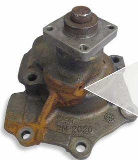
由于锈迹斑斑的冷却液变得泄漏的水泵(冷却液缺乏腐蚀防护)
