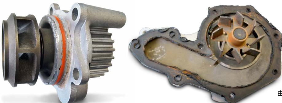
由于使用液态密封剂泄漏的水泵
