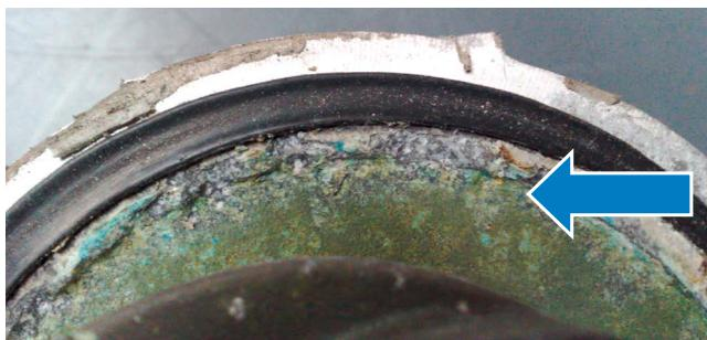
不合适的冷却液造成腐蚀和泄漏
